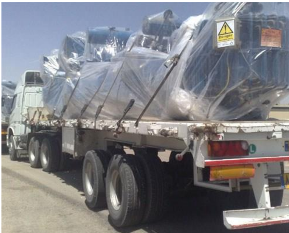
شکل ۹: نمایی از فرآیند بارگیری و انتقال ترانس های آسکارل جهت امحاء
